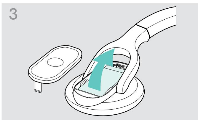
> Rimuovere la batteria ricaricabile e allentare con attenzione la spina del connettore della batteria ricaricabile.
