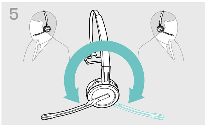
> Drehen Sie den Mikrofonarm, um die Trageseite zu wechseln.
