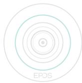
«Панель для совместной работы» включается автоматически при подключении к источнику питания. Светодиод загорится мятно-зеленым светом. Если лампа горит красным светом, устройство находится в режиме ожидания (см. стр. 25). Подключенный спикерфон также включится, и светодиод загорится белым.
