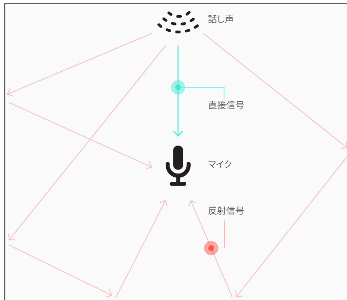
図 1.1: マイクに到達する直接信号と反射信号
