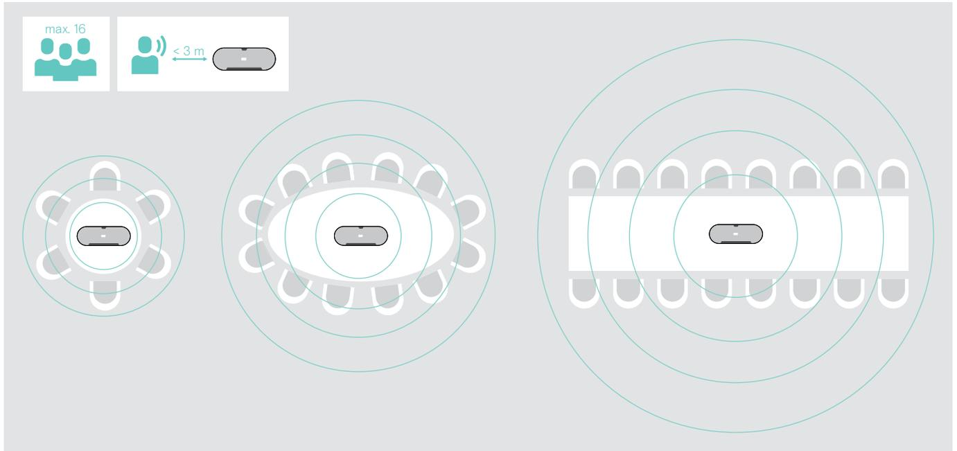
Für größere Räume können Sie Erweiterungsmikrofone anschließen. Mit jedem Mikrofon ist es für bis zu 8 zusätzliche Teilnehmer geeignet.
