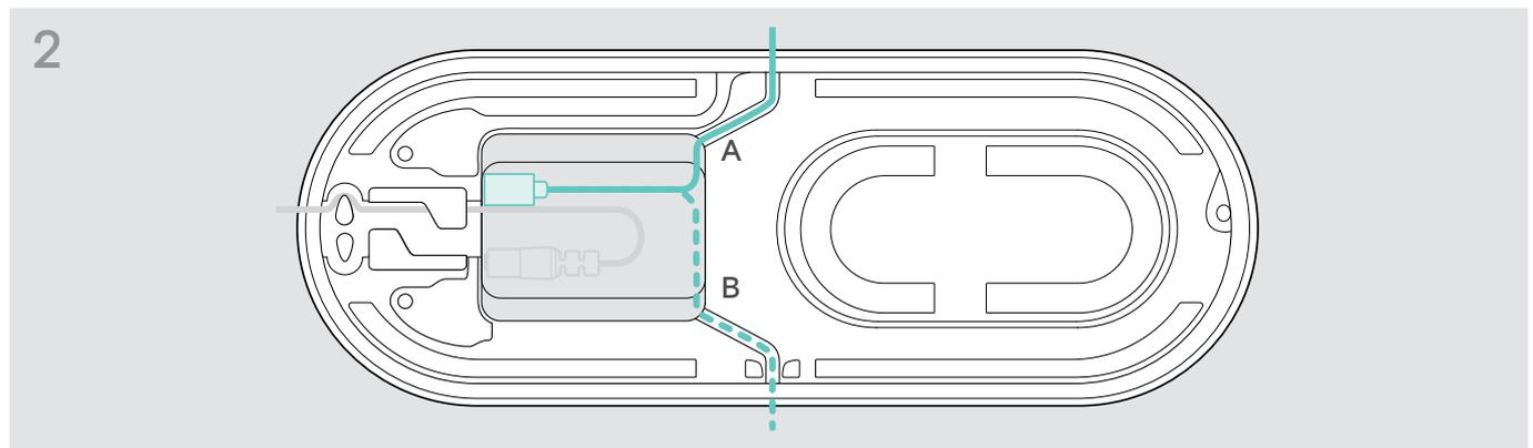
> Verlegen Sie das Kabel im Kabelkanal (A oder B), um es zu sichern.
