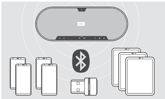
Das Speakerphone kann bis zu acht gekoppelte Bluetooth-Geräte speichern. Beim Anmelden eines neunten Bluetooth-Geräts, wird das am wenigsten verwendete Gerät überschrieben. Um das erste Gerät später wieder zu verwenden, melden Sie das Speakerphone erneut an.
