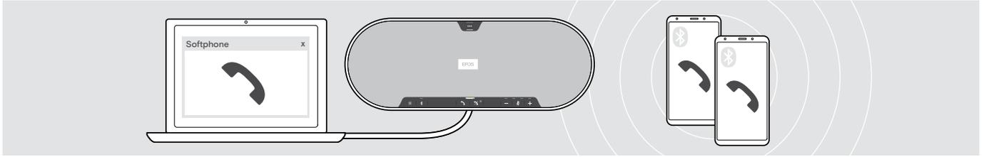
Sie können das Speakerphone mit bis zu drei verbundenen Geräten verwenden, von denen eines über USB und zwei über Bluetooth verbunden sind. Zwei Telefonate können gleichzeitig verwaltet werden. Wenn Sie während eines aktiven Gesprächs einen weiteren Anruf erhalten, wird ein Anklopfen eingespielt.
