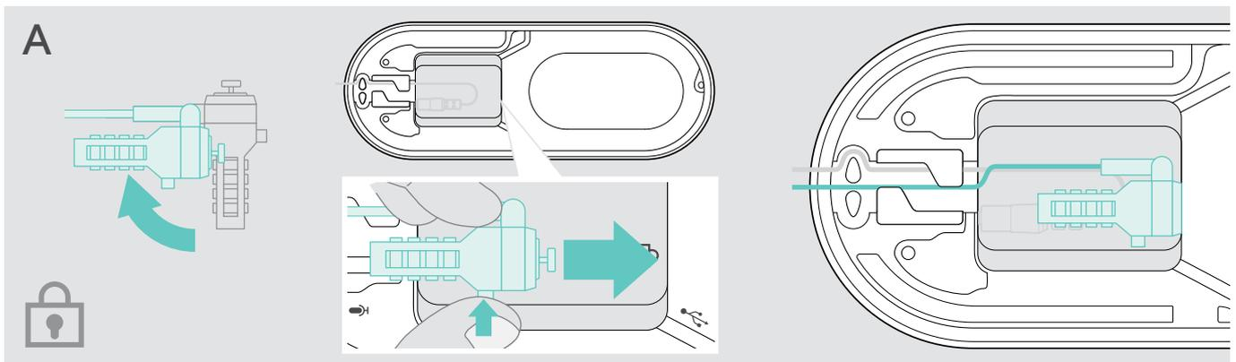
Die Öffnung für das Kensington-Schloss im Speakerphone ist optimiert für Kombinationsschlösser mit T-Bar-Schnittstelle und Draht mit einem Durchmesser von weniger als 5 mm.
