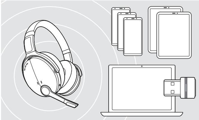
Um Daten via Bluetooth zu übertragen, müssen Sie das Headset zuerst mit einem kabellosen Gerät koppeln. Der mitgelieferte Dongle ist bereits mit dem Headset gekoppelt.
